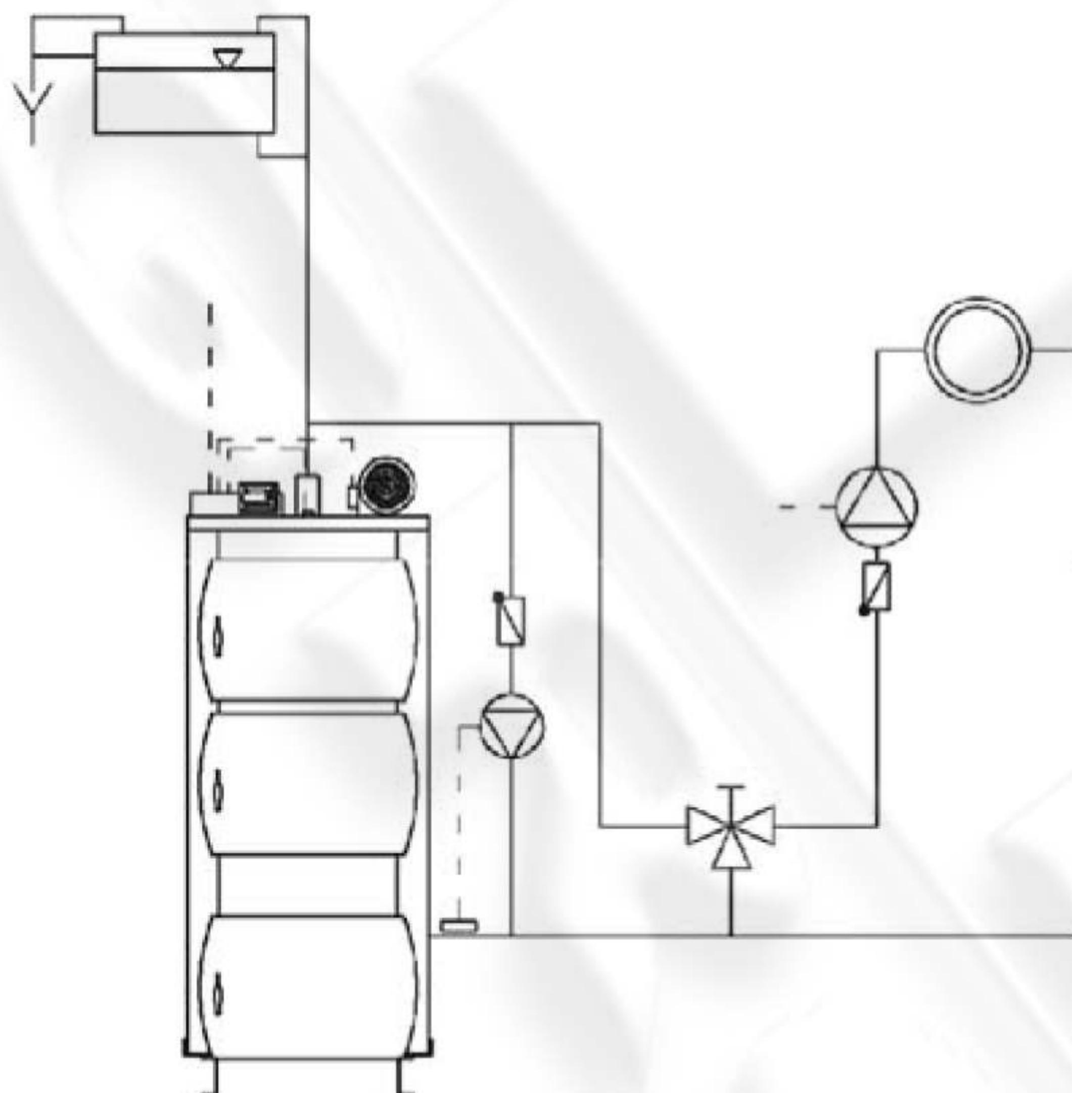
Подключение с 3-х ходовым клапаном и водонагревателем
